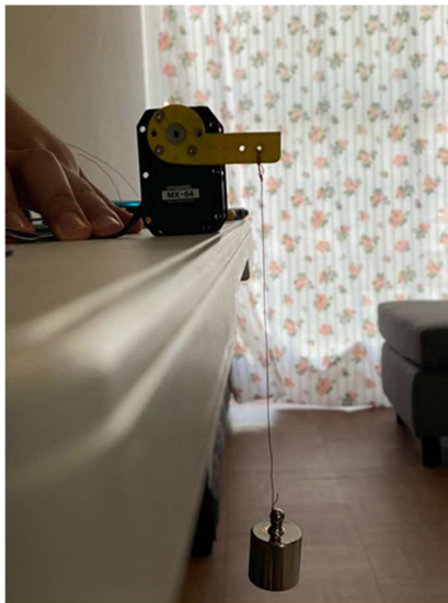
Ilustración 28. Ángulo inicial posicionado para levantar pesos y medir corriente demandada.
