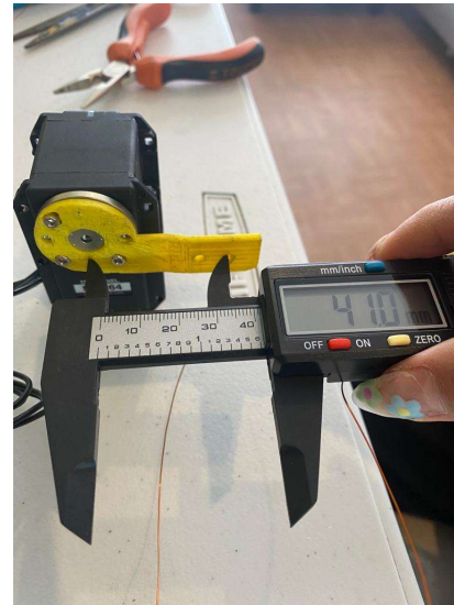
Ilustración 29. Distancia medida entre centro de motor y punto de palanca (0.041 m).
