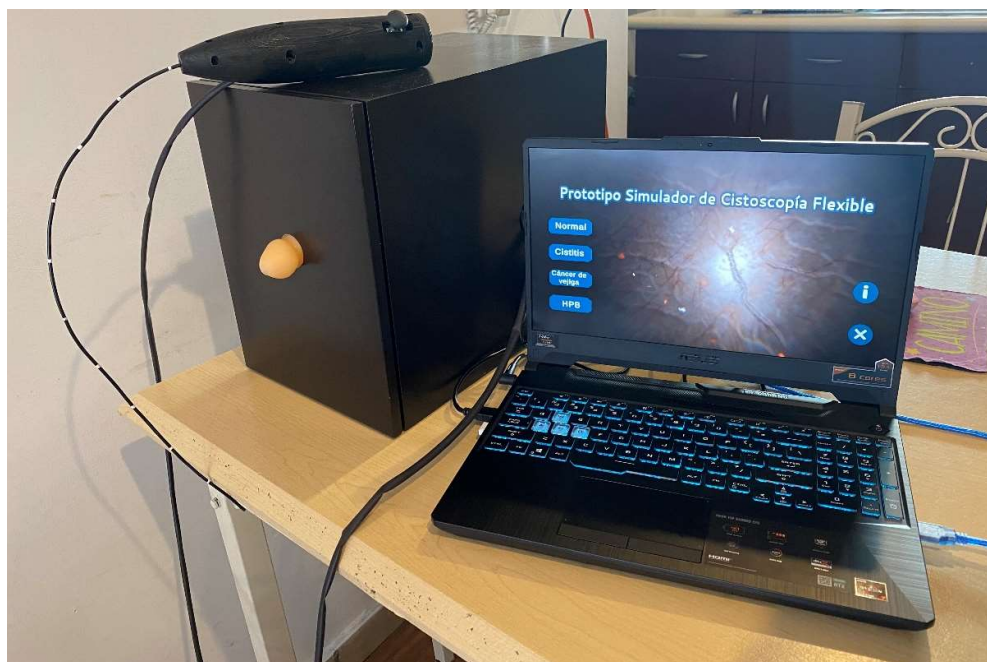
Ilustración 82. Unión de mecanismo electromecánico con simulación virtual 3D de prototipo simulador de cistoscopia flexible.
