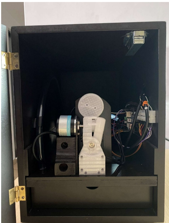
Ilustración 78. Acondicionamiento de sensores y actuadores a un microcontrolador con impresiones de cilindros, pinza como mecanismo háptico y embudo vista frontal.
